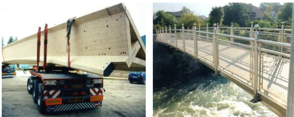
Slika 12: Premostitveni nosilec in most iz križno lepljenih lesenih KLH elementov.
